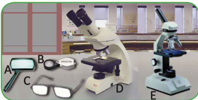
Fakkii 2.2: Gosoota maayikrooskoppii salphaa adda addaa (A fi B leensota guddistuu fi C leensota dubbisaa) fi gosa maayikrooskoppii kompaawundii (D abbaa ilaaltuu lamaa fi E abbaa ilaaltuu tokkoo)
