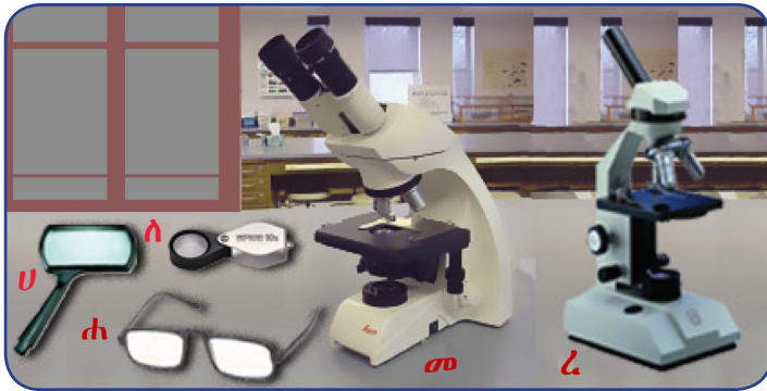
ስእሊ. 2.1 ዝተፈላለዩ ዓይነታት ቀሊል ማይክሮስኮፕ፡- ('ሀ' ን 'ሐ' ን መግዘፊ ሌንስታትን 'ሐ' መንበዚ መነጻጸር) ክምሕ' ውን ዝተፈላለዩ ዓይነታት ኮምፓውንድ ማይክሮስኮፕ (መ ክልተኣዊ መርኣዩ. 'ረ' ሓደኣዊ መርኣዩ.)
