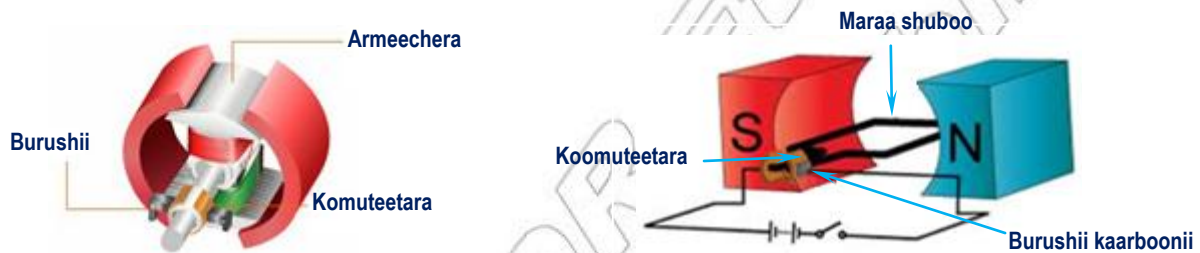
Fig. 5.43 Fakkii bu'uura motorra elektirikii
