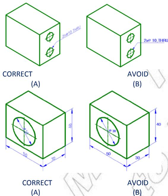
**Fig. 4.24. Pictorial dimensioning**
